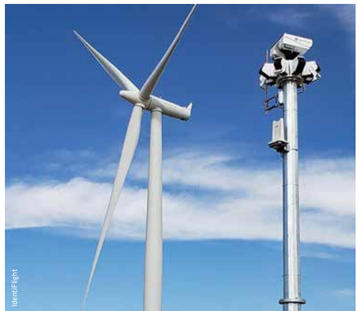
Mit acht Weitwinkelkameras beobachtet das Identiflight-System rundum potenzielle Vogelbewegungen. Wird eine Bewegung erkannt, erfassen die zwei darüber dreh- sowie schwenkbar montierten Zoomkameras das Objekt und bestimmen Flugrichtung sowie Geschwindigkeit. Besteht Gefahr, schaltet das System Windräder zum Schutz der Vögel zeitweise ab.
