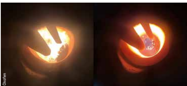
Lodernde Flammen versucht Ökofen mit der „Zero Flame“ Technik zu vermeiden. Die Abgaswerte verbessern sich durch die neue Technik erheblich.
