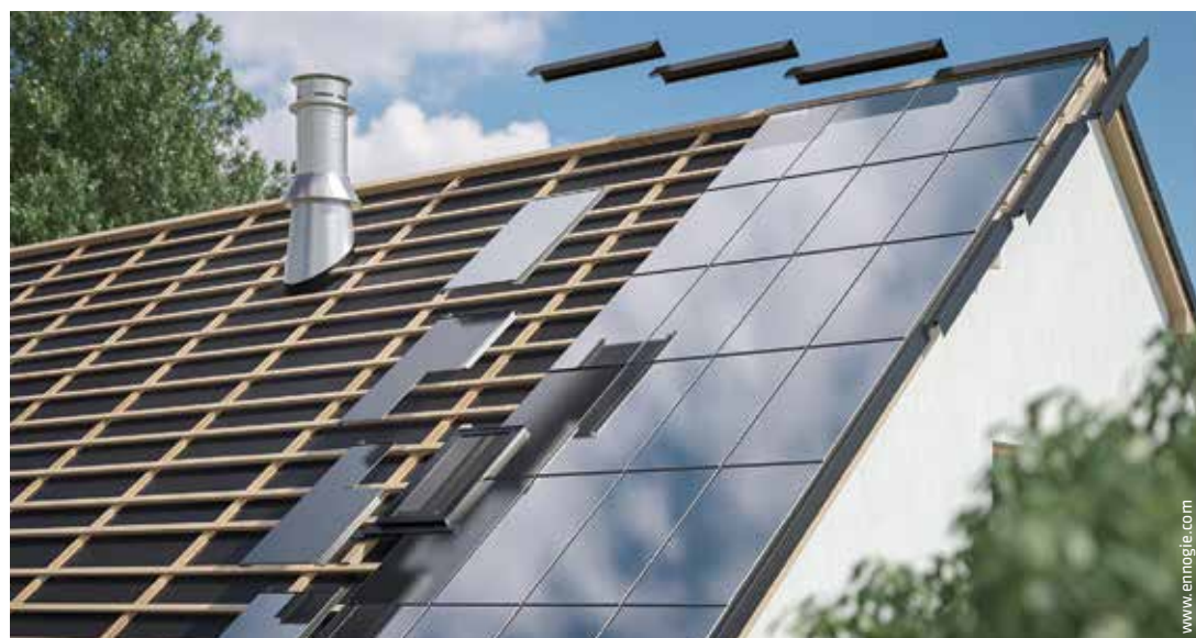
Das Ennogie-System setzt auf flächig schwarze Glas-Glas-PV-Module als Dacheindeckung, die überlappend montiert werden und damit eine wetterfeste Dachhaut bilden. Für Randbereiche werden vor Ort zuschneidbare „Anpassungsmodule“ ohne Stromerzeugung angeboten, sodass eine optisch einheitliche Dacheindeckung erfolgen kann.
