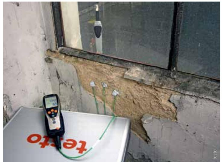
Das Messgerät verfügt über mehrere Sensoren, die auf der Innenseite des zu messenden Bauteils angeklebt werden und ein per Funk angebundenes Außenmodul. Aus der Temperaturdifferenz errechnet das Gerät eigenständig den tatsächlichen Wärmedämmwert von Außenwänden und Fensterscheiben.
