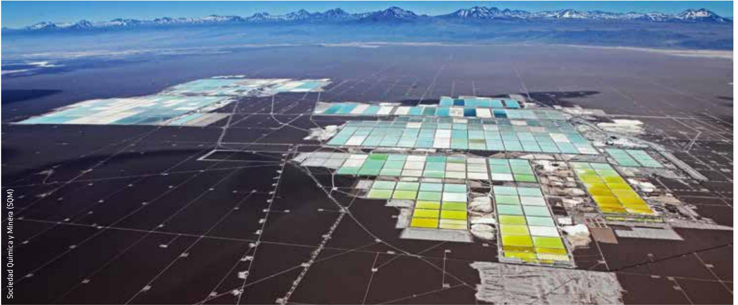
Zur Lithiumgewinnung wird, wie hier in Chile, das weltweit mit Abstand über die größten Lithium-Vorkommen verfügt, Sole aus der Erde in Solarteiche gepumpt. Aus dem nach der Verdunstung übrigbleibenden Lithiumcarbonat wird in weiteren Prozessen Lithium gewonnen.
